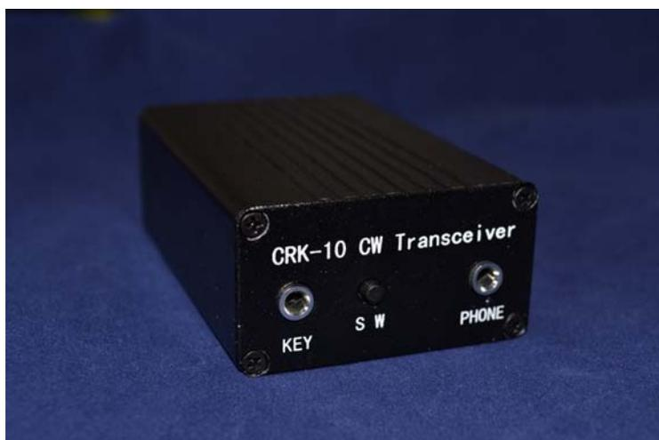
CRK-10の送信出力は3W (12V 電源の時) 電源電圧範囲は9-15V です。送信時電流は500mA、受信時電流はわずか15mA (12V にて実測) です。組込の MCU は700Hz のサイドトーンを発生、送受を切り替え、パドルキーヤーとして働くだけでなく、縦振れ電鍵、バグキーにも対応しています。
